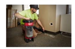
Бесщеточный мотор POWERSTATE™ и всасывание циклонного типа обеспечивают мощность всасывания 1557 л/мин, вместимость 3,8 л и давление 189 мбар для очистки от пыли гипсокартона, бетонной пыли, древесной и металлической стружки, а также другого строительного мусора быстрее и эффективнее.
