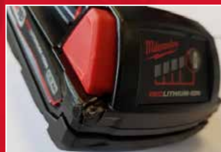
Exempel på yttre påverkan (kraftigt slag)
