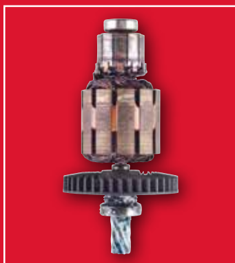
Bränd motor på grund av överbelastning
