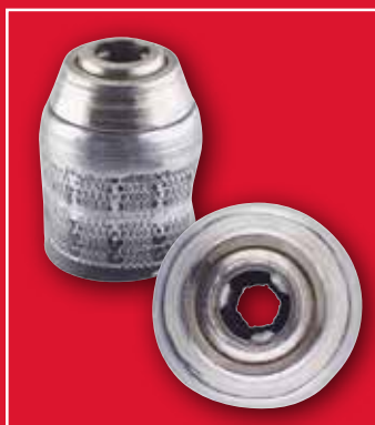
Trasig chuck på grund av felaktig användning
