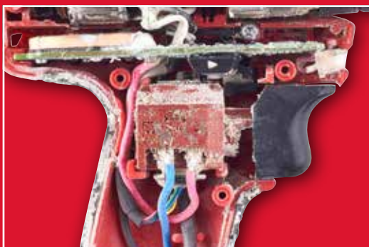
Strömbrytare kan inte användas på grund av smuts i verktyget
