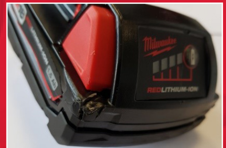
Exempel på yttre påverkan (kraftigt slag)
