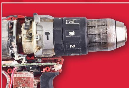
Пример чрезмерного износа
