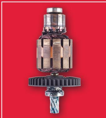
Двигатель сгорел вследствие перегрузки
