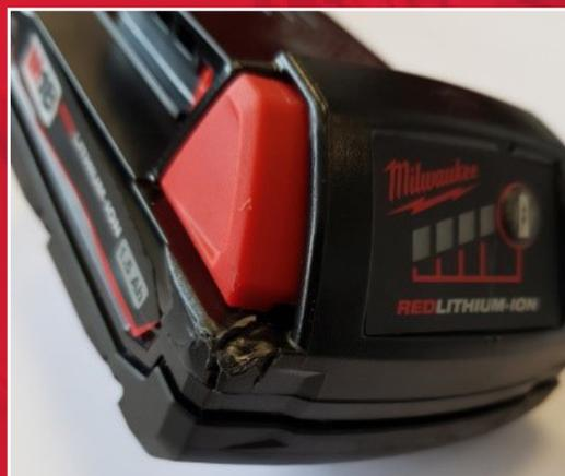
Пример сильного внешнего воздействия на аккумулятор MILWAUKEE® (падение или удар)
