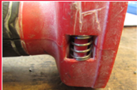
Fjæren er montert eksternt, noe som er bevis på uautorisert åpning av verktøyet
