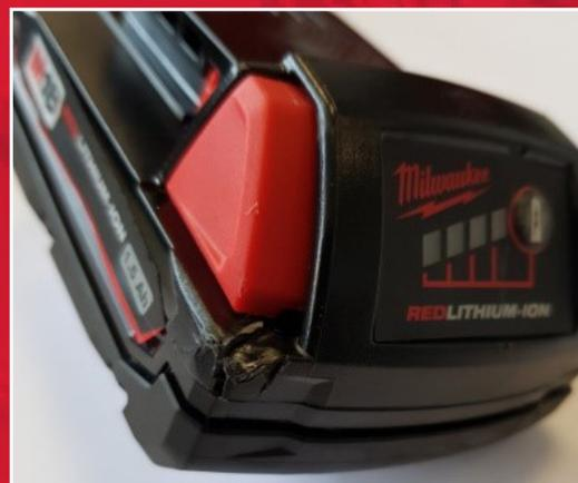
Esempio di caduta estrema o impatto di una batteria MILWAUKEE®
