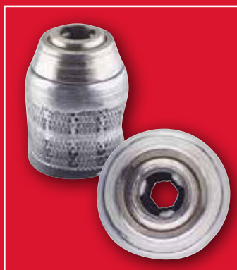
Ødelagt borepatron pga. forkert brug
