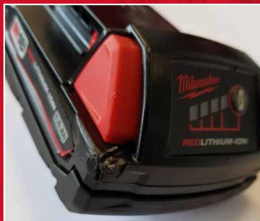
Eksempel på et ekstremt fald eller stød for et MILWAUKEE®-batteri
